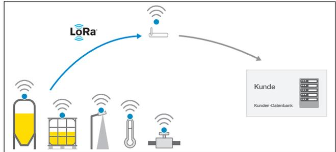
Abb. 19: Drahtlose Messwertübertragung
