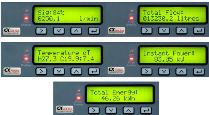
Nach Eingabe der Messstellenparameter startet der CLOU-1000E sofort den Signalabgleich. Nachdem ein gültiges Signal erkannt ist, werden die Signalstärke sowie der aktuelle Momentanwert angezeigt. Die aktuelle Fließrichtung wird als positive Richtung definiert. Im Bedienmenü können weitere Einstellungen wie die Skalierung des Zählimpulsausgangs oder der Schleichmengenunterdrückung vorgenommen werden. Um versehentliche Änderungen zu verhindern, ist die Bedienung passwortgeschützt.
