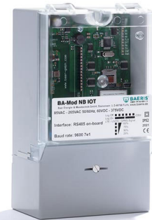
Das BA-Mod NB IOT unterstützt weltweite Netzfrequenzen auf Basis LTE Cat M1/NB2
