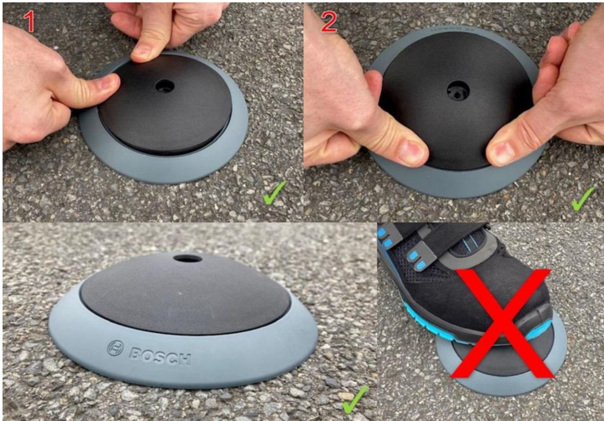
Figura 11 Instalação do sensor - exemplo
