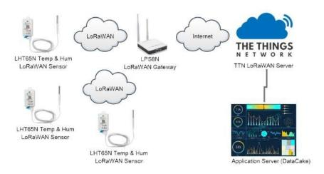
Angenommen, das LPS8N ist bereits für die Verbindung mit dem TTN V3-Netzwerk (https://eu1.cloud.thethings.network) eingerichtet, sodass es die Netzabdeckung für das LHT65N bereitstellt. Als Nächstes müssen wir das Gerät in TTN V3 registrieren:
