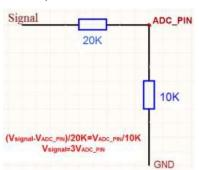
Wenn der ADC IN1-Pin mit GND verbunden oder suspendiert ist, beträgt der ADC-Wert 0.
