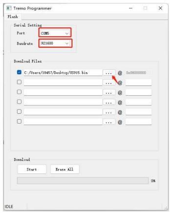
Knoten zurücksetzen: Schließen Sie den Anschluss 3 (RST) des E2-Kabels kurz mit GND. Klicken Sie dann auf die Schaltfläche "Start", um die Firmware-Aktualisierung zu starten.
