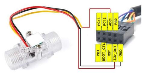
Fall 2: Normaler Durchflusssensor: Ein solcher Durchflusssensor hat einen höheren Stromverbrauch und ist nicht für die Stromversorgung durch den LHT65N geeignet. Er wird über eine externe Stromversorgung mit Strom versorgt und gibt
