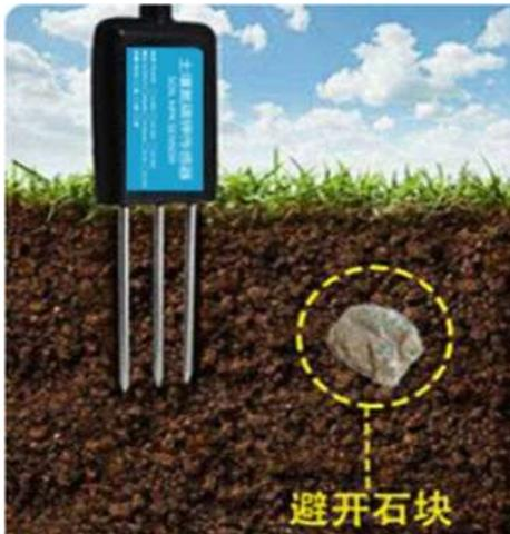
Wählen Sie die richtige Messposition. Vermeiden Sie, dass die Sonde Felsen oder harte Gegenstände berührt. Teilen Sie die Oberflächenerde entsprechend der gemessenen Tiefe auf. Behalten Sie die gemessene Dichte als Ausgangspunkt bei. Führen Sie die Sonde senkrecht in den zu messenden Boden ein. Achten Sie darauf, dass Sie beim Einführen nicht wackeln.
