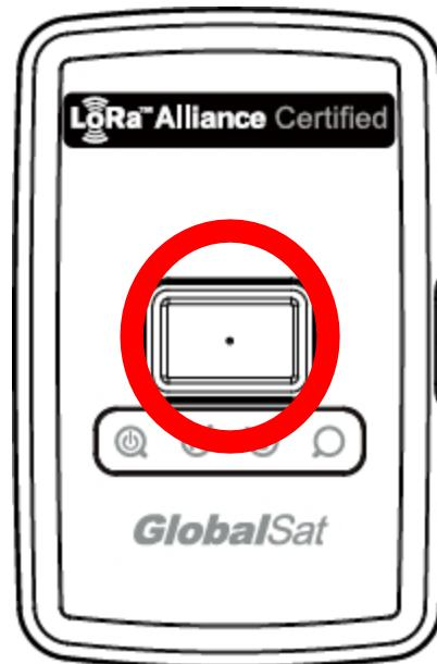
Wenn die Hilfe-Taste lange gedrückt wird, sendet das LT-100 sofort den ersten Hilfebericht. Anschließend sendet das LT-100 alle 30 Sekunden (Standardwert) kontinuierlich Hilfeberichte an das LoRaWAN™-Gateway, bis es eine Serverbestätigung und eine GPS-Ortung erhält.
