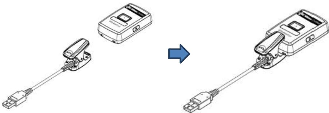
Wenn Sie das Gerät zum ersten Mal verwenden, muss der Akku vollständig aufgeladen werden, bevor das LT-100 betriebsbereit ist. Um die Lebensdauer des Akkus Ihres Geräts zu maximieren, führen Sie die folgenden Schritte aus.
