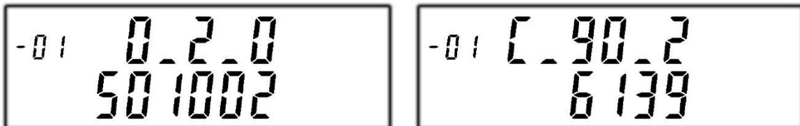
Sofern ein Kommunikationsadapter „BAB-01“ angebunden wird, zeigt das Display dann seine Software-Versionsnummer und die dazugehörigen Prüfsumme an. Die Software-Version wird mit dem Index 2 angegeben.
