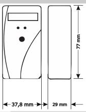
Der EHKV Euris II (Kompaktversion) wird mit dem modernen, weitreichenden LoRa<sup>™</sup>-Funkstandard geliefert. Er ist mit einer Taste ausgestattet, über die der Funk und die Anzeige aktiviert werden können. Die optische Schnittstelle ermöglicht eine individuelle Konfiguration durch den Kunden.
