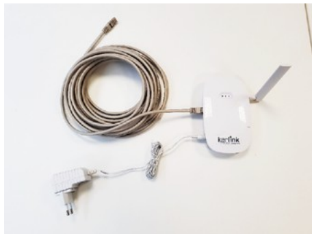
Ethernet-Kabel, Stromversorgung und LoRa-Antennenanschlüsse
