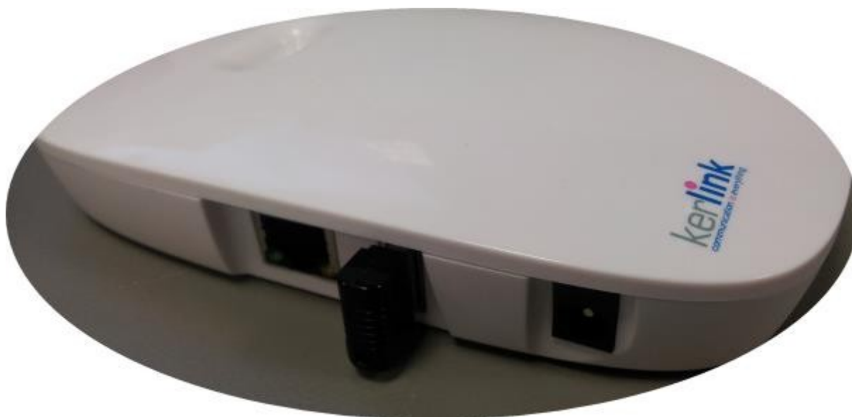
Abbildung 48: USB-Dongle am Wirnet™ iFemtoCell
