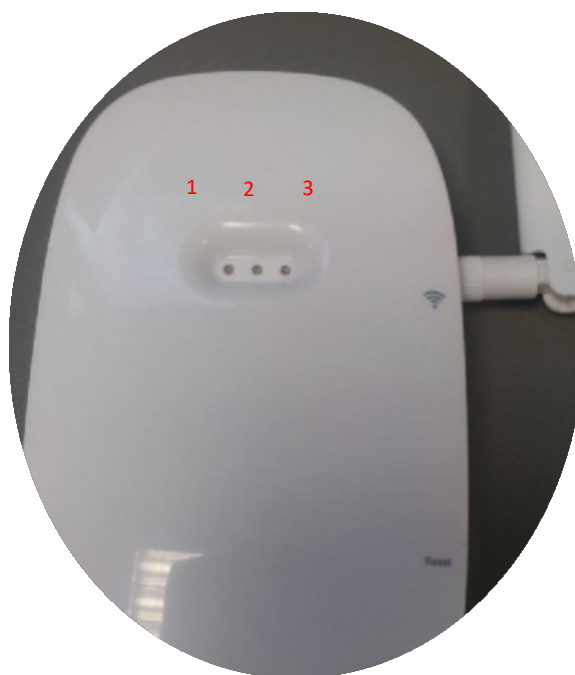
Abbildung 47: Wartungsprüfung mit LEDs
