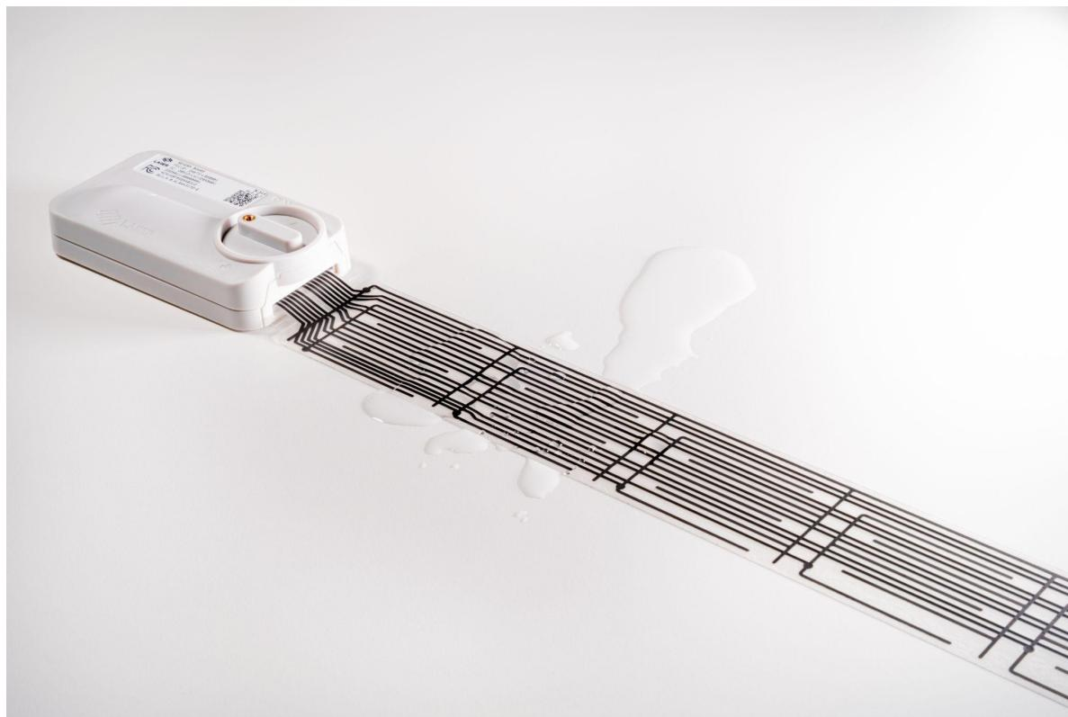
Severn WLD ist das Wasserleckerkennungsgerät von LAIIER. Die Severn WLD-Hardware wird an einen gedruckten Sensor angeschlossen, der in 12 Abschnitte oder Elektroden unterteilt ist. Nach dem Einschalten mit einer einzigen AA-Li-SOCl2-Zellenbatterie verbindet sich das Gerät über OTAA mit dem LoRaWAN®-Netzwerk. Nach einem Selbsttest wechselt das Gerät in den Betriebsmodus.
