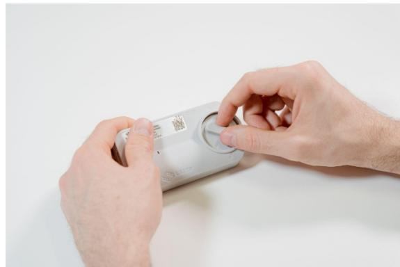
2. Öffnen Sie den Anschluss, den beigen Teil an der Vorderseite des Geräts, indem Sie den schwarzen Hebel des Anschlusses nach oben ziehen, und setzen Sie den Sensor mit der bedruckten Seite nach oben ein. Setzen Sie den Sensor vollständig ein und achten Sie darauf, dass beide Laschen an den Seiten des Sensors Kontakt mit der Außenseite des Gerätegehäuses haben.
