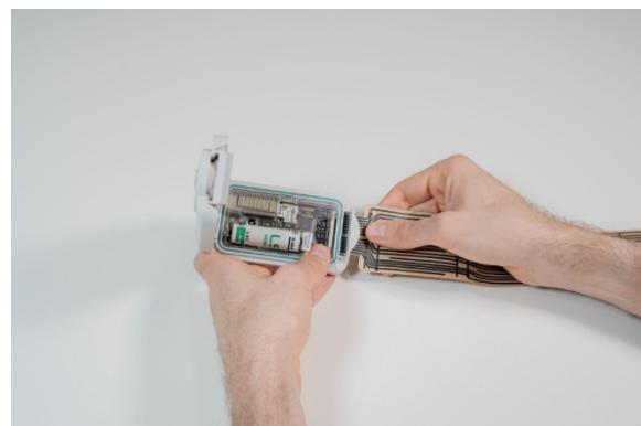
3. Schließen Sie den Stecker, indem Sie den schwarzen Hebel nach unten drücken. Überprüfen Sie, ob der Sensor richtig angeschlossen ist, indem Sie leicht daran ziehen.
