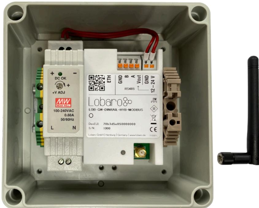
Das Lobaro Hybrid Modbus Gateway ext. Power, 230 V ist mit externen Anschlüssen für RS485 / Modbus, Ethernet / LAN ausgestattet. Es ist kompatibel zu Modbus ASCII / RTU. Darüber hinaus kann es mit 230V über Netzteil oder 12-24 V betrieben werden. Der Upload erfolgt via NB-IoT Mobilfunk (LTE Bänder: 3, 8, 20) oder alternativ via LoRaWAN v1.0.2 (EU-868).
