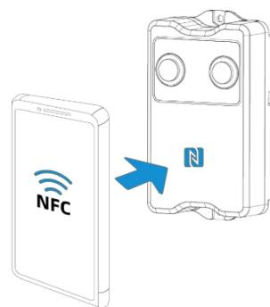
4. Grundlegende Informationen und Einstellungen der Geräte werden in der ToolBox angezeigt, wenn sie erfolgreich erkannt wurden. Sie können das Gerät durch Antippen der Schaltfläche in den Apps ein- und ausschalten sowie lesen und schreiben. Um die Sicherheit der Geräte zu gewährleisten, ist bei der Konfiguration über ein unbenutztes Telefon eine Passwortüberprüfung erforderlich. Das Standardpasswort lautet 123456.
