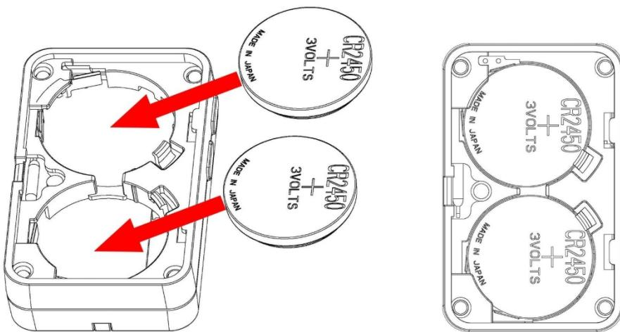
Hinweis: Verwenden Sie zum Einbau der Batterie einen Schraubendreher oder ein ähnliches Werkzeug, um die Batterieabdeckung zu öffnen.
