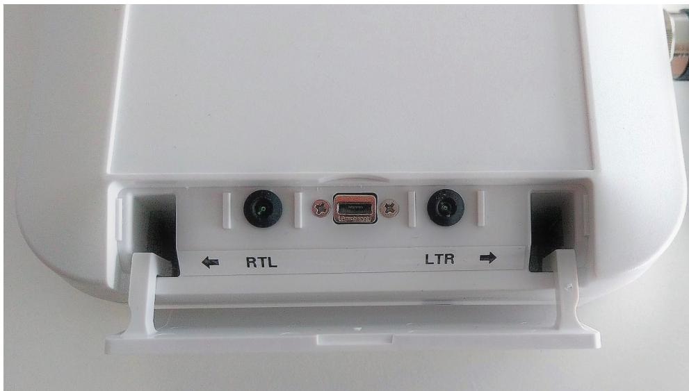
Die TCR-Verkehrszähler unterscheiden zwischen zwei Fahrtrichtungen.
