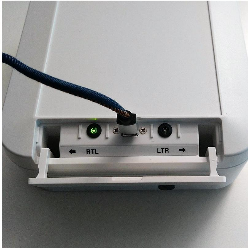
Öffnen Sie die Serviceklappe und schließen Sie ein USB-zu-Micro-USB-Kabel an. Schließen Sie das andere Ende an einen USB-Anschluss eines Windows-PCs an. Die RTL-LED sollte zu blinken beginnen.
