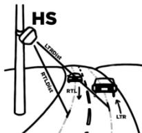
**Zwei Fahrspuren, Querverkehr (2L2D)** Dies ist typisch für HS-Anwendungen wie die Verkehrsmessung auf Autobahnen. RTLDist und LTRDist sind unterschiedlich.
