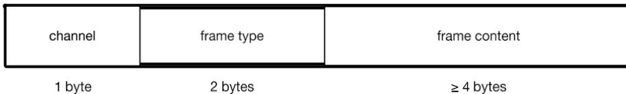
**1 Byte für Kanal**, Standardwert 1, bedeutet, dass der Sensor ordnungsgemäß angeschlossen ist.
