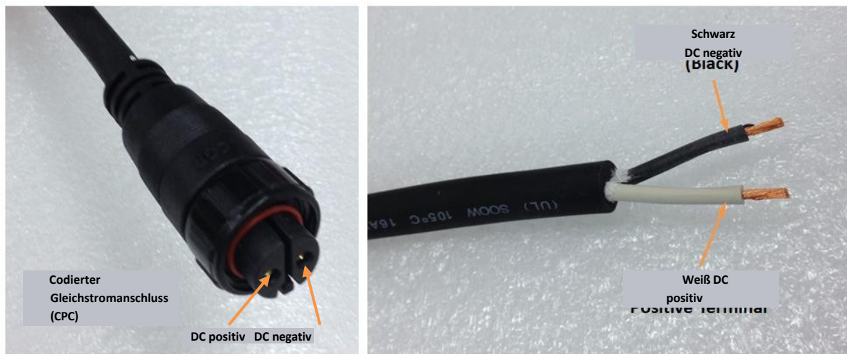
Abbildung 6: Polarität des CPC-Anschlusses für Gleichstromversorgung
