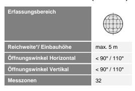
Bei einer Einbauhöhe von 2,5 m ergibt sich ein quadratischer Erfassungsbereich von ca. 5 x 5 m, bzw. ein kreisförmiger Erfassungsbereich von ca.  $\varnothing$  7 m aufgeteilt in 32 Messzonen.
