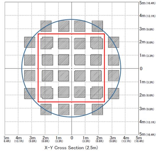
Bei einer Einbauhöhe von 2,5 m ergibt sich ein quadratischer Erfassungsbereich von ca. 5 x 5 m, bzw. ein kreisförmiger Erfassungsbereich von ca. Ø 7 m aufgeteilt in 32 Messzonen.
