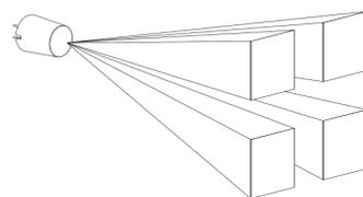
Eine Linse teilt den Erfassungsbereich in 32 Messbereiche auf. Der Sensor erkennt Änderungen der Infrarotstrahlung, welche auftreten, wenn sich ein Objekt\* (oder eine Person) bewegt, dessen IR-Temperatur von der Umgebung abweicht.
