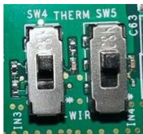
Abbildung 11: Schalter 3 und 4 mit den Standardpositionen „SW4“ und „SW5“
