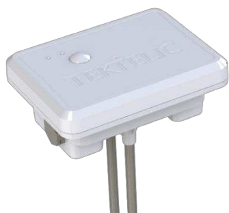
Abbildung 1 Landwirtschaftssensor für die Bodenoberflächenmontage
