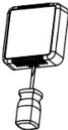
Die Abdeckung des Sockels muss mit einem Schlitzschraubendreher abgenommen werden.
