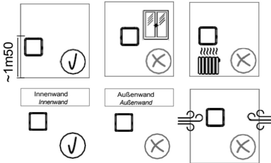
Die Installation muss an einer Wand in 1,50 m Höhe über dem Boden erfolgen, die keinen Kontakt zur Außenwelt hat. Der Kollektor muss fern von Fenstern und Wärmequellen (Sonne, Heizkörper, Lüftung, Lufteinlass) angebracht werden.
