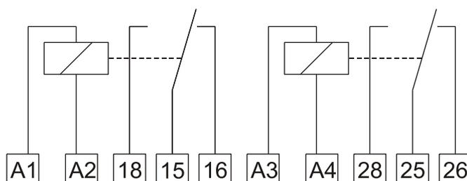
Das Relais 7PA0048/0049 verfügt über zwei elektronische Wischimpulseingänge und zwei potentialfreie Umschaltkontakte.
