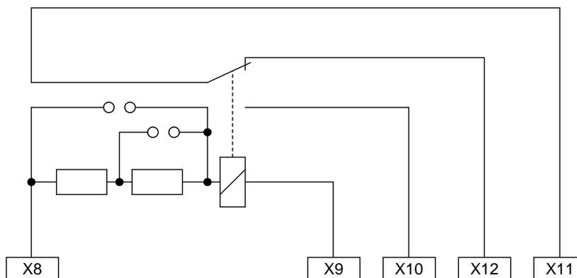
Das Relais dient in Fernzähl-, Summenfernzähl- und Maximumüberwachungsanlagen zur galvanischen Trennung, Umsetzung und Vervielfachung von Impuls- bzw. Signalstromkreisen. Es besitzt zwei Eingänge und zwei galvanisch getrennte Ausgänge. Die Impulse werden 1:1 weitergegeben.
