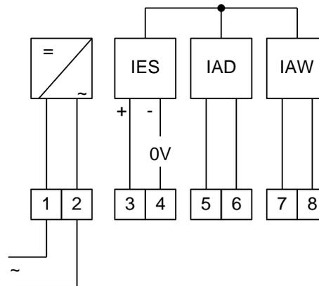
Das Hilfsrelais 7FRS01W1D dient in Fernzähl-, Summenfernzähl- und Maximumüberwachungsanlagen zur galvanischen Trennung und Verstärkung von Impulsen bzw. Signalstromkreisen. Das Relais 7FRS01W1D verfügt über einen S0-Eingang, einen elektronischen Doppelstromimpulsausgang und einen Wischimpulsausgang.
