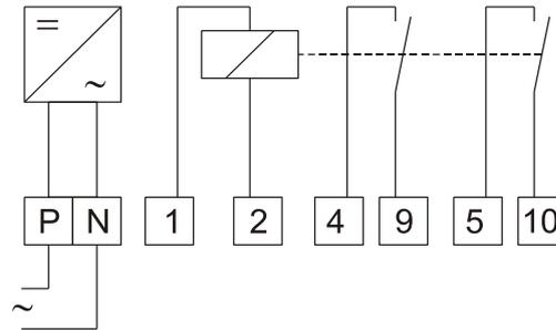
Das Relais 7PAW2Wt verfügt über einen elektronischen Wischimpulseingang und zwei elektronische Wischimpulsausgänge, die über einen Timer angesteuert werden (feste Impulslänge von ca. 90ms).
