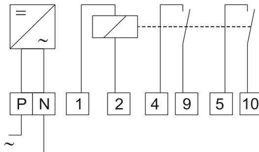
Das Relais 7PAW2W verfügt über einen elektronischen Wischimpulseingang und zwei elektronische Wischimpulsausgänge.
