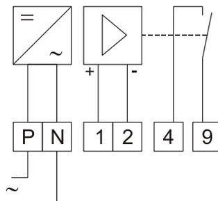
Das Relais 7PAS01Wt verfügt über einen aktiven S0-Eingang und einen elektronischen Wischimpulsausgang, die über einen Timer angesteuert werden (feste Impulslänge von ca. 90ms).
