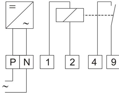
Das Relais 7PAW1W verfügt über einen elektronischen Wischimpulseingang und einen elektronischen Wischimpulsausgang.
