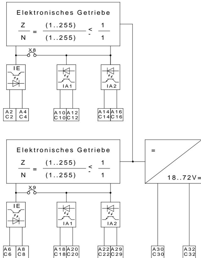
Das Relais dient in Fernzähl-, Summenfernzähl- und Maximumüberwachungsanlagen zur galvanischen Trennung, Umsetzung und Vervielfachung von Impuls- bzw. Signalstromkreisen.
