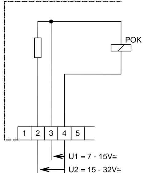
Das Hilfsrelais 7FR5021 dient in Fernzähl-, Summenfernzähl- und Maximumüberwachungsanlagen zur galvanischen Trennung und Verstärkung von Impulsen bzw. Signalstromkreisen. Das Relais 7FR5021 verfügt über einen Wischsignaleingang und einen quecksilberbenetzten Wischsignalausgang (Hinweis: nicht geeignet für Impulsübertragung!).
