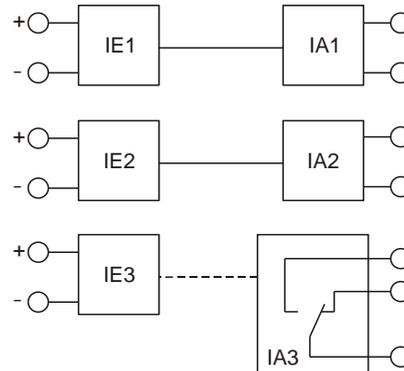
Das Relais dient in Fernzähl-, Summenfernzähl- und Maximumüberwachungsanlagen zur galvanischen Trennung und Umsetzung von Impuls- bzw. Signalstromkreisen. Es besitzt drei Eingänge und drei galvanisch getrennte Ausgänge zuzüglich drei Leuchtdioden.
