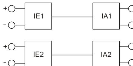
Das Relais dient in Fernzähl-, Summenfernzähl- und Maximumüberwachungsanlagen zur galvanischen Trennung und Umsetzung von Impuls- bzw. Signalstromkreisen. Es besitzt zwei Eingänge und zwei galvanisch getrennte Ausgänge zuzüglich zwei Leuchtdioden.
