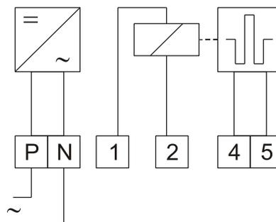
Das Relais 7PAW1D verfügt über einen elektronischen Wischimpulseingang und einen aktiven elektronischen Doppelstrom-Ausgang.
