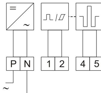
Das Relais 7PAI1D verfügt über einen induktiven Eingang und einen aktiven elektronischen Doppelstrom-Ausgang.
