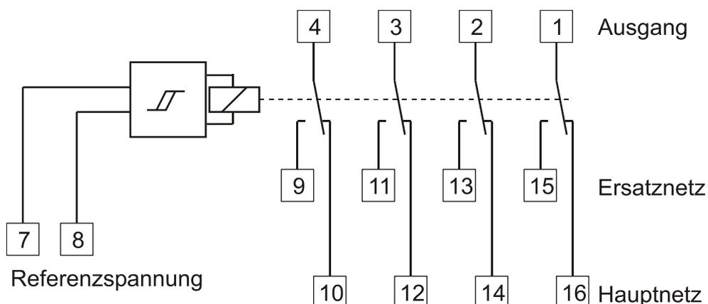
Das Spannungsauswahlrelais 7PWSU4Um schaltet zwischen Haupt- und Ersatznetz um, falls die Referenzspannung (110VAC oder 230VAC) unter eine vorgegebene Schwelle abfällt (85% der Nennspannung).
