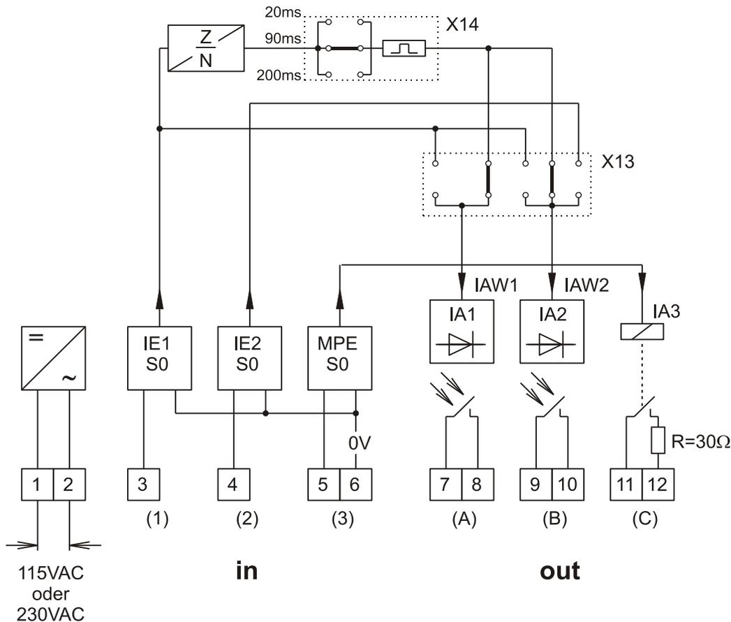
Das Hilfsrelais 7FR5071 dient in Fernzähl-, Summenfernzähl- und Maximumüberwachungsanlagen zur galvanischen Trennung und Verstärkung von Impulsen bzw. Signalstromkreisen.
