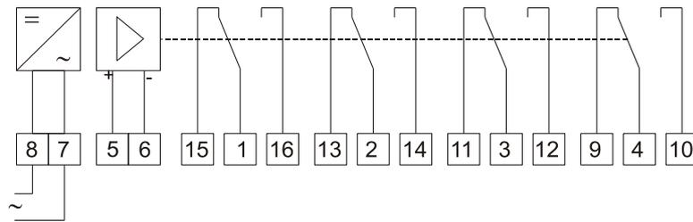
Das Relais 7PW0213 verfügt über einen aktiven S0-Eingang (für passive Wischimpulsgeber bis 40VDC) und vier Umschaltkontakte. Dieses Hilfsrelais ist für die Zähler selbstüberwachungssysteme von Siemens bestimmt.
