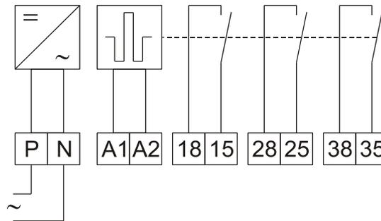
Das Relais 7PAD3W verfügt über einen passiven elektronischen Doppelstrom-Eingang und drei passive elektronische Wischimpulsausgänge.
