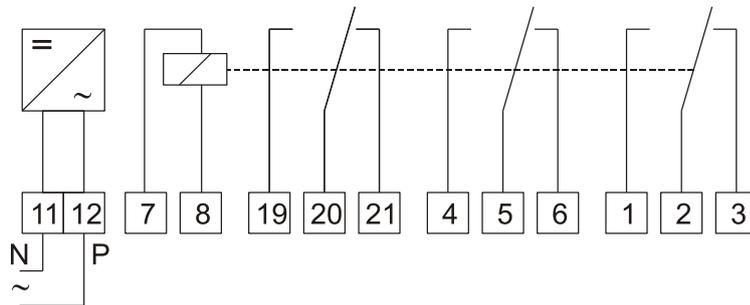
*Nur mit Hilfsspannung sind die Kontakte geschlossen*
