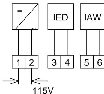
Das Hilfsrelais 7FRD1W dient in Fernzähl-, Summenfernzähl- und Maximumüberwachungsanlagen zur galvanischen Trennung und Verstärkung von Impulsen bzw. Signalstromkreisen. Das Relais 7FRD1W verfügt über einen elektronischen Doppelstromeingang und einen Wischimpulsausgang.
