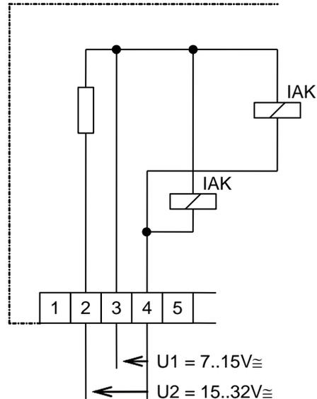
Das Hilfsrelais 7FR5022 dient in Fernzähl-, Summenfernzähl- und Maximumüberwachungsanlagen zur galvanischen Trennung und Verstärkung von Impulsen bzw. Signalstromkreisen. Das Relais 7FR5022 verfügt über einen Wischimpulseingang und zwei quecksilberbenetzte Wischimpulsausgänge.
