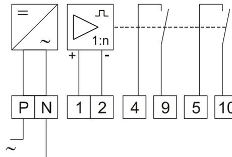
Das Relais 7PAS02Wtg verfügt über einen aktiven S0-Eingang und zwei elektronische Wischimpulsausgänge, die über einen Timer angesteuert werden (feste Impulslänge von ca. 2s). Die eingehenden Impulse werden über ein eingebautes Impulsgetriebe im Verhältnis 1:10 oder 1:100 untersetzt.
