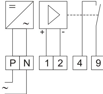
Das Relais 4NWS01W eignet sich aufgrund seiner Abmessungen speziell für den Einbau in Verteilungen mit geringer Einbautiefe. Es besitzt einen S0-Impulseingang und einen galvanisch getrennten Wischimpulsausgang zuzüglich einer Leuchtdiode.
