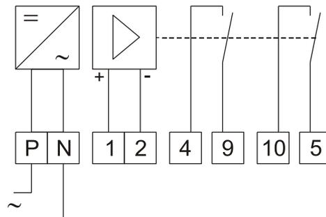
Das Relais 7PAS02W verfügt über einen aktiven S0-Eingang und zwei elektronische Wischimpulsausgänge.
