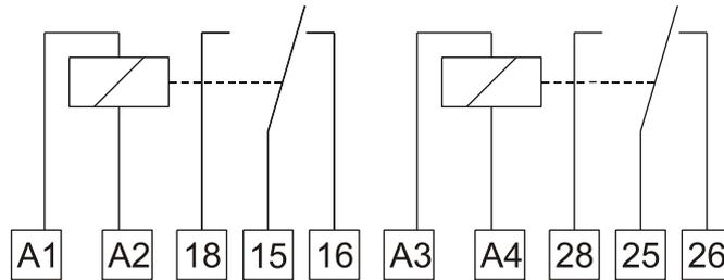
Das Relais 7PA0011 verfügt über zwei elektromagnetische Wischimpulseingänge und zwei potentialfreie Umschaltkontakte.
