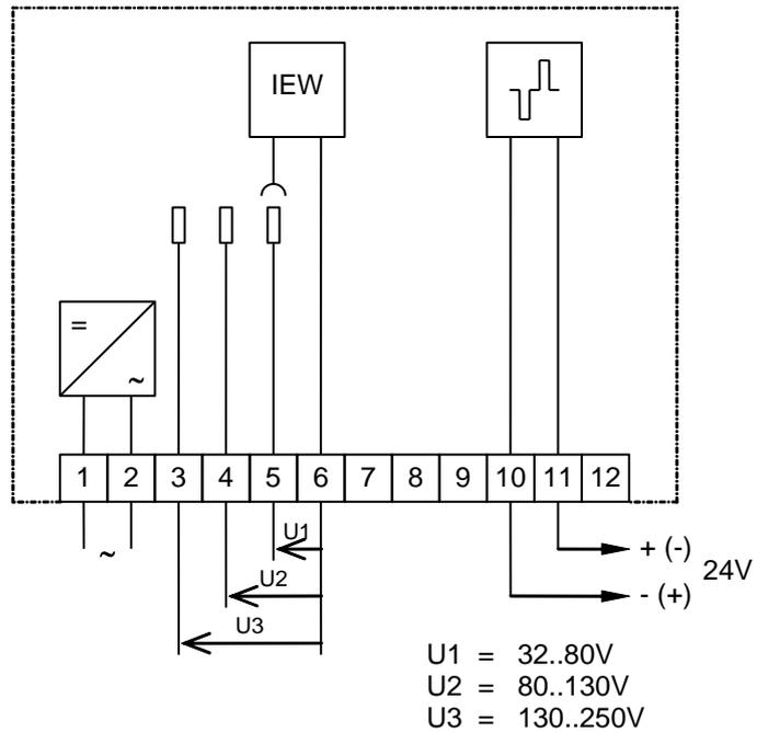
Das Hilfsrelais 7FR5053 dient in Fernzähl-, Summenfernzähl- und Maximumüberwachungsanlagen zur galvanischen Trennung und Verstärkung von Impulsen bzw. Signalstromkreisen. Das Relais 7FR5053 verfügt über einen passiven Signaleingang und einen Doppelstromimpulsausgang.
