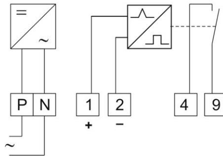
Das Relais 7PAA1W verfügt über einen Eingang für Analogsignal (4..20mA) und einen elektronischen Wischimpulsausgang. Die Impulsfrequenz am Ausgang ist proportional zu dem Eingangsstrom:
