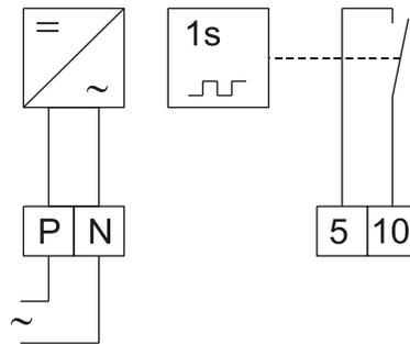
Das Taktgeber-Relais 7PATG1 erzeugt aus der 50Hz Netzwechselfspannung Sekundenimpulse für eine Vielzahl von Zeitmessaufgaben. Einsatzgebiete sind z.B. die Kontrolle von Messperioden- oder Tarifsignaldauer.
