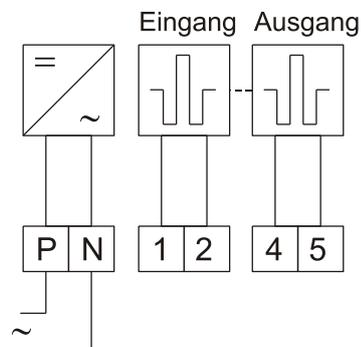
Das Relais 7PAD1D verfügt über einen passiven elektronischen Doppelstrom-Eingang und einen aktiven elektronischen Doppelstrom-Ausgang.
