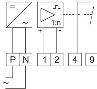
Das Relais 7PAS01Wtg verfügt über einen aktiven S0-Eingang und einen elektronischen Wischimpulsausgang, die über einen Timer angesteuert werden (feste Impulslänge von ca. 2s). Die eingehenden Impulse werden über ein eingebautes Impulsgetriebe im Verhältnis 1:10 oder 1:100 untersetzt.
