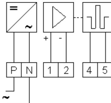
Das Relais 7PAS01D verfügt über einen aktiven S0-Eingang und einen aktiven elektronischen Doppelstrom-Ausgang.
