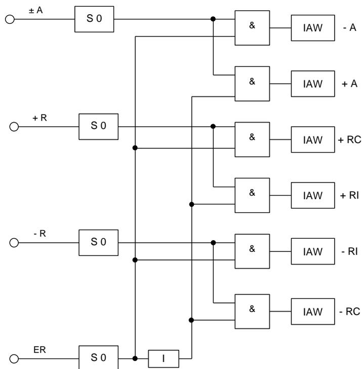
Das Relais 7PD4QS0W verfügt über vier aktive S0-Eingänge und sechs elektronische Wischimpulsausgänge. Entsprechend der Energierichtung "ER" (Lieferung / Bezug) werden die Impulse auf entsprechende Ausgänge umgeleitet (vier Quadranten-Unterscheidung).
