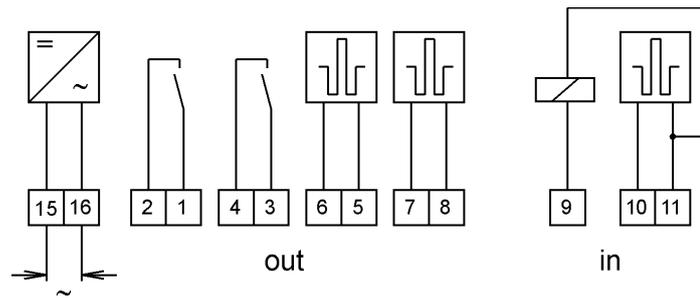
Das Hilfsrelais RWD03mod dient in Fernzähl-, Summenfernzähl- und Maximumüberwachungsanlagen zur galvanischen Trennung und Verstärkung von Impulsen bzw. Signalstromkreisen.
