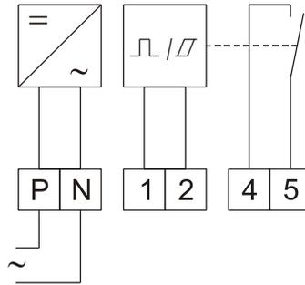
Das Relais 7PAI1W verfügt über einen induktiven Eingang und einen elektronischen Wischimpulsausgang.
