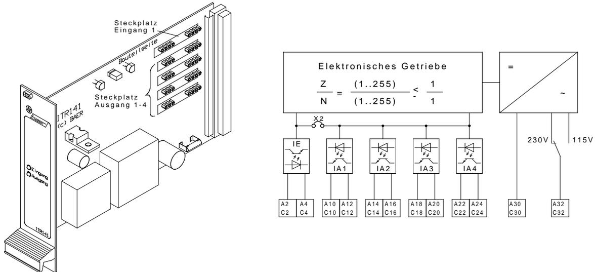
Das Relais dient in Fernzähl-, Summenfernzähl- und Maximumüberwachungsanlagen zur galvanischen Trennung, Umsetzung und Vervielfachung von Impuls- bzw. Signalstromkreisen.
