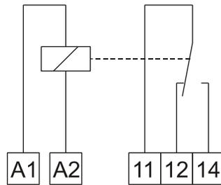
Das Relais 2NW6190 eignet sich aufgrund seiner Abmessungen speziell für den Einbau in Verteilungen mit geringer Einbautiefe. Es besitzt einen Wischimpulseingang und einen Wischimpulsausgang (Umschaltkontakt).
