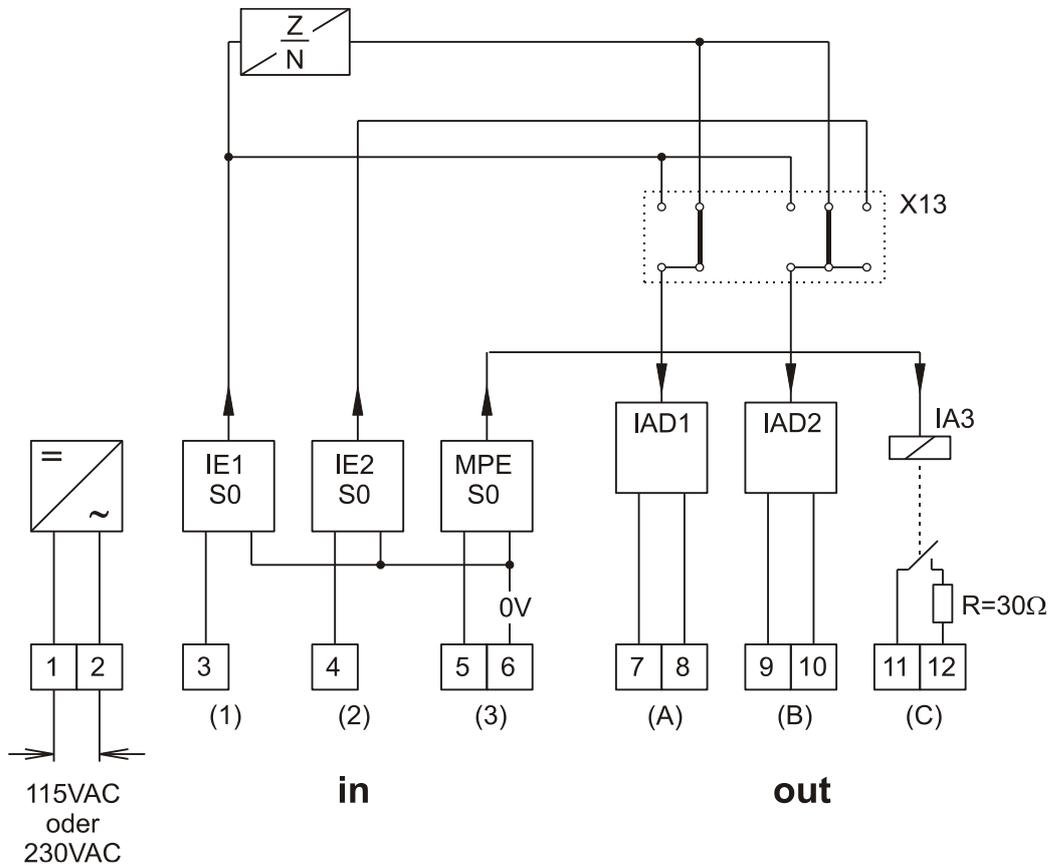
Das Hilfsrelais 7FR5073 dient in Fernzähl-, Summenfernzähl- und Maximumüberwachungsanlagen zur galvanischen Trennung und Verstärkung von Impulsen bzw. Signalstromkreisen.
