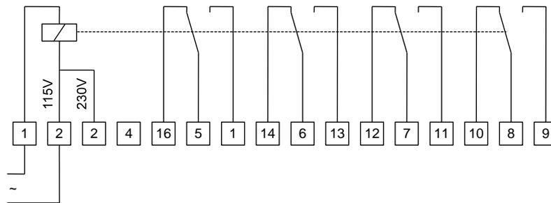
Das Relais 7PW0113-X verfügt über einen umklemmbaren elektronischen Wischimpulseingang und vier Umschaltkontakte.
