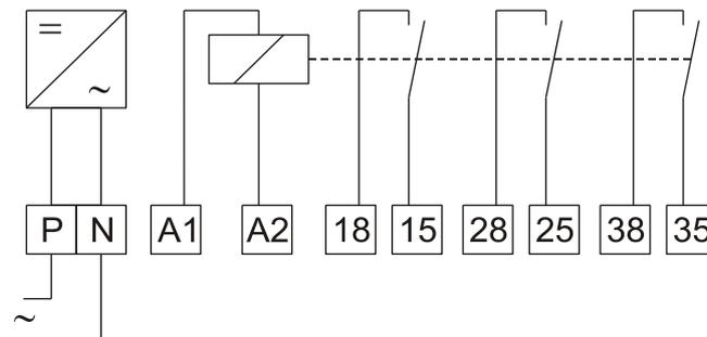
Das Relais 7PAW3W verfügt über einen elektronischen Wischimpulseingang und drei elektronische Wischimpulsausgänge.
