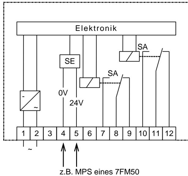
Das Hilfsrelais 7FR5046 dient in Fernzähl-, Summenfernzähl- und Maximumüberwachungsanlagen zur galvanischen Trennung und Verstärkung von Impulsen bzw. Signalstromkreisen. Das Relais 7FR5046 verfügt über einen aktiven Signaleingang und zwei potentialfreie Umschaltkontakte.
