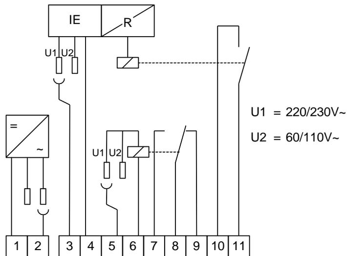
Das Hilfsrelais 7FR5067 dient in Fernzähl-, Summenfernzähl- und Maximumüberwachungsanlagen zur galvanischen Trennung und Verstärkung von Impuls- bzw. Signalstromkreisen.
