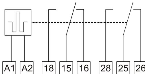
Das Relais 7PA0024 verfügt über einen elektronischen Doppelstrom-Eingang und zwei potentialfreie Umschaltkontakte.
