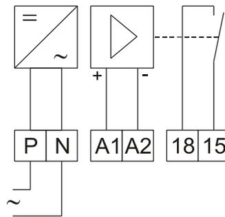
Das Relais 7PAS01W verfügt über einen aktiven S0-Eingang und einen elektronischen Wischimpulsausgang.
