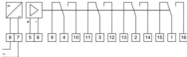
Das Relais 7PW0113 verfügt über einen aktiven S0-Eingang (für passive Wischimpulsgeber bis 40VDC) und vier Umschaltkontakte. Dieses Hilfsrelais ist für die Zähler selbstüberwachungssysteme von Siemens bestimmt.
