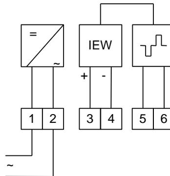
Das Hilfsrelais 7FRW1D dient in Fernzähl-, Summenfernzähl- und Maximumüberwachungsanlagen zur galvanischen Trennung und Verstärkung von Impulsen bzw. Signalstromkreisen. Das Relais 7FRW1D verfügt über einen Wischimpulseingang und einen elektronischen Doppelstrom-Ausgang.
