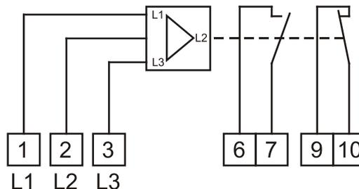
Das Relais 7PASU3Wm dient in dreiphasigen Netzen (Wandlerspannung: 110VAC) zur Ausfallüberwachung. Es wird in Dreieck-Schaltung betrieben (ohne Neutralleiter) und meldet den Ausfall einer oder mehrerer Phasen durch einen Fehlerkontakt, der als Öffner und Schließer zur Verfügung steht.
