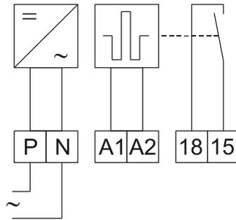
Das Relais 7PAD1W verfügt über einen passiven elektronischen Doppelstrom-Eingang und einen passiven elektronischen Wischimpulsausgang.
