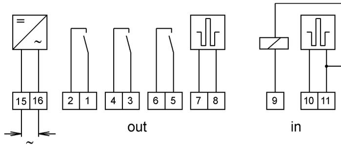
Das Hilfsrelais RWD03 dient in Fernzähl-, Summenfernzähl- und Maximumüberwachungsanlagen zur galvanischen Trennung und Verstärkung von Impulsen bzw. Signalstromkreisen.
