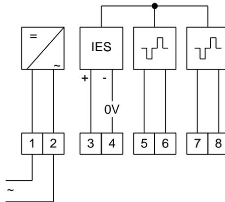
Das Hilfsrelais 7FRS02D dient in Fernzähl-, Summenfernzähl- und Maximumüberwachungsanlagen zur galvanischen Trennung und Verstärkung von Impulsen bzw. Signalstromkreisen. Das Relais 7FRS02D verfügt über einen S0-Eingang und zwei elektronische Doppelstrom-Ausgänge.
