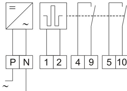
Das Relais 7PAD2W verfügt über einen passiven elektronischen Doppelstrom-Eingang und zwei passive elektronische Wischimpulsausgänge.
