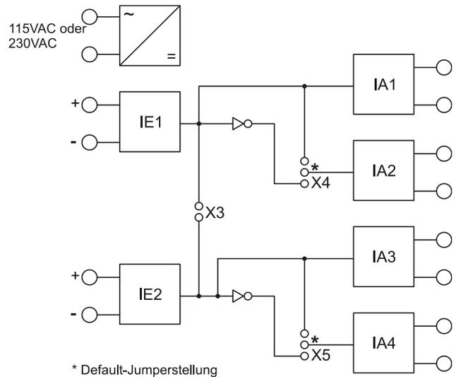
Das Relais dient in Fernzähl-, Summenfernzähl- und Maximumüberwachungsanlagen zur galvanischen Trennung, Umsetzung und Vervielfachung von Impuls- bzw. Signalstromkreisen.
