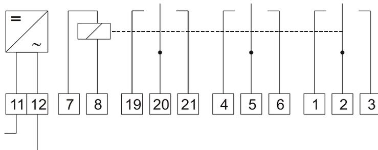
*Ohne Hilfsspannung sind alle Kontakte geöffnet*
