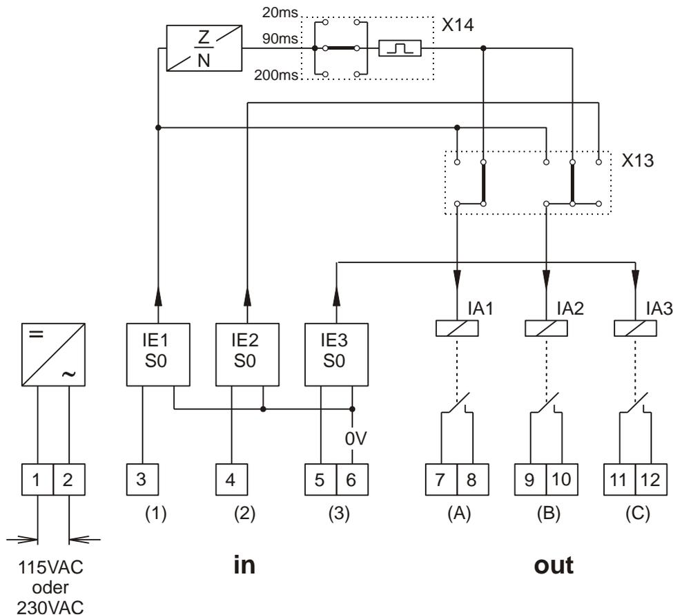
Das Hilfsrelais 7FR5072 dient in Fernzähl-, Summenfernzähl- und Maximumüberwachungsanlagen zur galvanischen Trennung und Verstärkung von Impulsen bzw. Signalstromkreisen.
