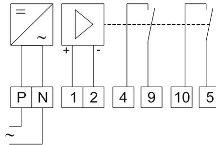
Das Relais 7PAS02Wt verfügt über einen aktiven S0-Eingang und zwei elektronische Wischimpulsausgänge, die über einen Timer angesteuert werden (feste Impulslänge von ca. 90ms).
