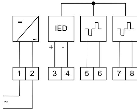
Das Hilfsrelais 7FRD2D dient in Fernzähl-, Summenfernzähl- und Maximumüberwachungsanlagen zur galvanischen Trennung und Verstärkung von Impulsen bzw. Signalstromkreisen. Das Relais 7FRD2D verfügt über einen elektronischen Doppelstrom-Eingang und zwei elektronische Doppelstrom-Ausgänge.
