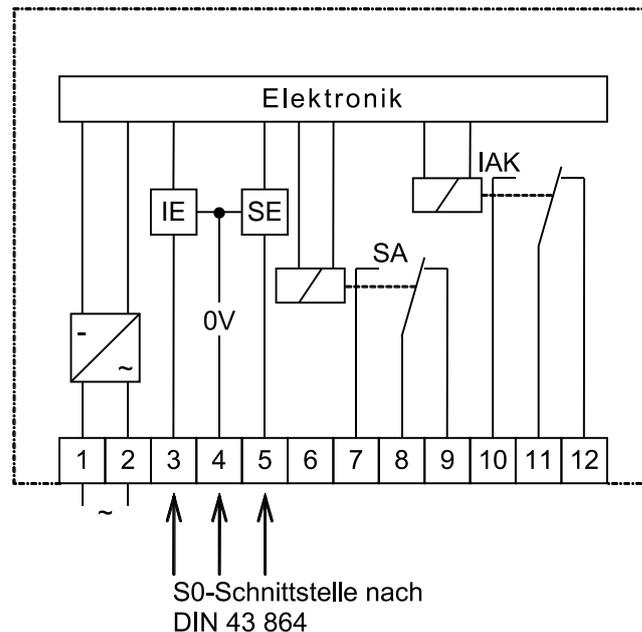
Das Hilfsrelais 7FR5048 dient in Fernzähl-, Summenfernzähl- und Maximumüberwachungsanlagen zur galvanischen Trennung und Verstärkung von Impulsen bzw. Signalstromkreisen.
