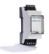
Der BA-MBM 10 THR ist ein Pegelumsetzer im DIN-Tragschienengehäuse (Breite 2TE=35mm, DIN 43880). Der MicroMaster wird zum physikalischen Anpassen zweier Schnittstellen eingesetzt: RS232 und M-Bus aktiv. Die Datenübertragung erfolgt voll transparent mit Baudraten zw. 300 und 19200 Baud.
