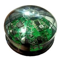
Die GreenBox Tiny Zhaga wird für die Einzelsteuerung bei der Strassenbeleuchtung eingesetzt.
