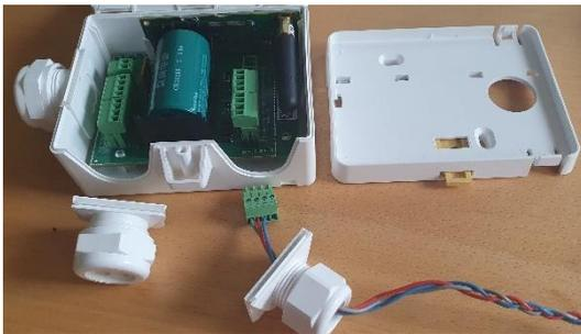
Steckbare Klemmen und herausnehmbare PG-Verschraubungen vereinfachen die Verdrahtung und die Inbetriebnahme.
