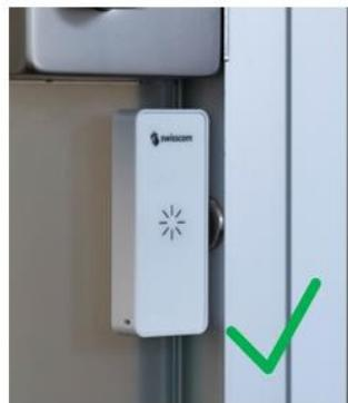
Testmodus: Für eine bessere Erfahrung während der Installation kann der Modus „*Reed-Installation & Test*“ verwendet werden. In diesem Modus löst jedes Reed-Ereignis eine Meldung und ein LED-Signal aus.
