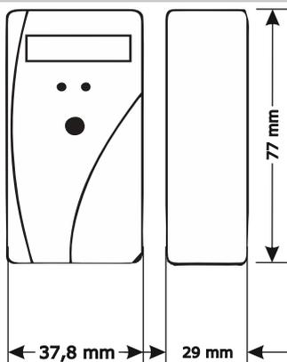
Der EHKV Euris II (Kompaktversion) wird mit dem modernen, weitreichenden LoRa™-Funkstandard geliefert. Er ist mit einer Taste ausgestattet, über die der Funk und die Anzeige aktiviert werden können. Die optische Schnittstelle ermöglicht eine individuelle Konfiguration durch den Kunden.
