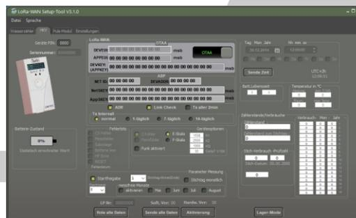
Der Betreiber kann die Geräte nach seinen Wünschen parametrieren. Die Kommunikation mit dem Gerät ist mit einer PIN gesichert, die das Gerät vor unbefugten Zugriff schützt. Die PIN kann auch über LoRa™ gesetzt oder aktiviert werden.
