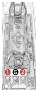
Schneiden Sie vor dem Anschließen des Kabels des externen Magnetdetektors den Kunststoff an der Unterseite gemäß der Abbildung aus. Verbinden Sie NICHT die beiden markierten und miteinander verdrillten Kabel. Verwenden Sie stattdessen die beiden Kabel ohne Markierung.
