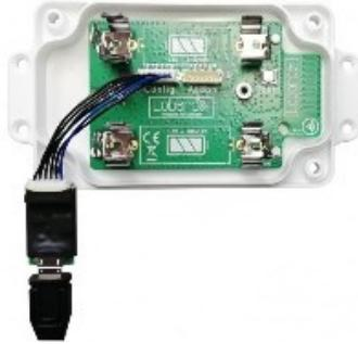
Der USB-Adapter verwendet einen sechsadrigen Stecker [der Serie JST-ZH](#) zum Anschluss an die Lobarowartungstool-Hardware am Konfigurationsanschluss.
