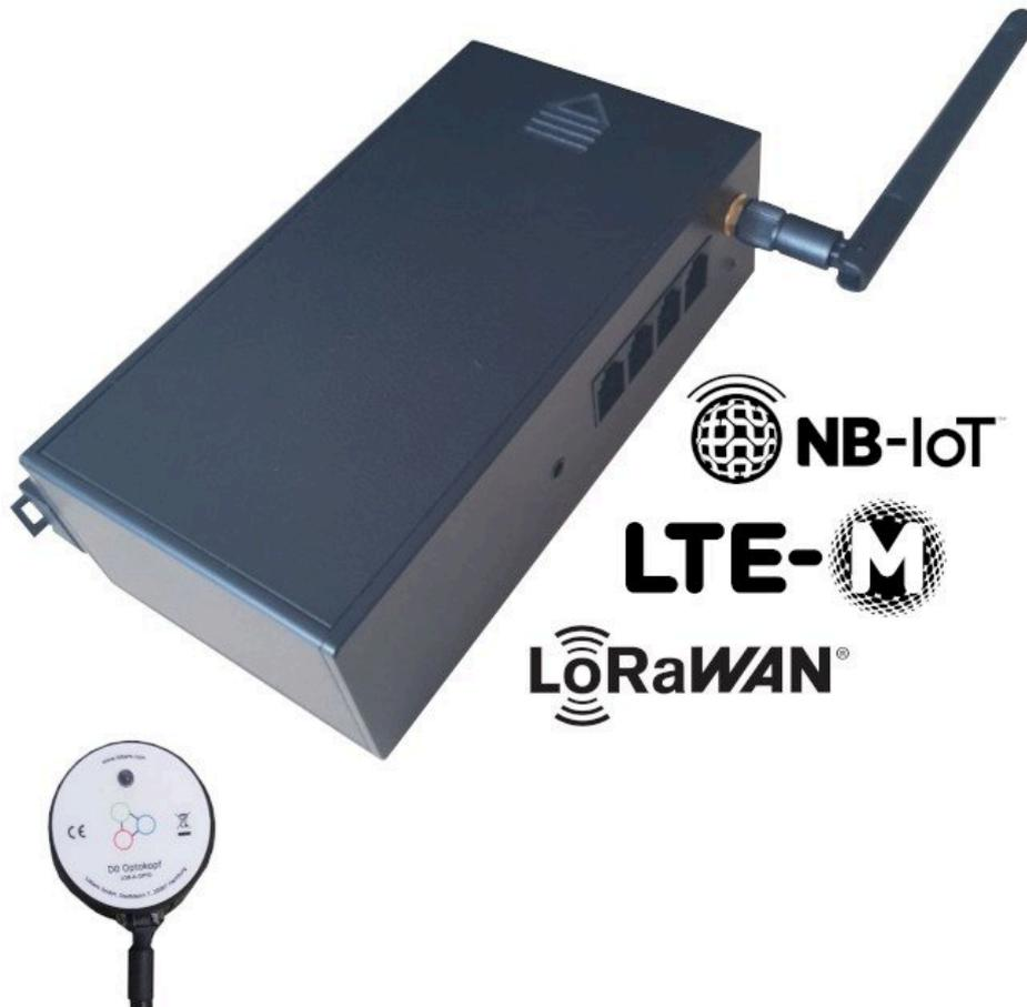
Gateway zur Fernauslesung von Stromzählern mit D0 / "INFO" Schnittstelle mittels LoRaWAN, NB-IoT oder LTE-M. Es können bis zu vier Stromzähler mit nur einem Dzero Gateway ausgelesen werden. Das Gerät unterstützt das SML Protokoll und IEC 62056-21.
