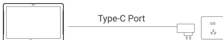
Verbinden Sie den Typ-C-Anschluss des IoT-Displays und die Steckdose mit einem Typ-C-Kabel.
