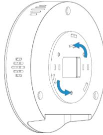
**Schritt 2:** Bohren Sie entsprechend der Montageplatte 3 Löcher in die Decke. Setzen Sie die Dübel in die Löcher ein und befestigen Sie dann die Montageplatte mit Schrauben.
