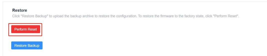
Das Gerät wird dann neu gestartet und sofort auf die Werkseinstellungen zurückgesetzt.
