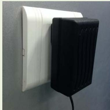
4. Das Gerät ist mit dem offenen Protokoll LoRaWAN Klasse C kompatibel, wodurch es bei Empfang des Downlink-Befehls Infrarotbefehle übertragen kann. Das Gerät unterstützt auch Fernbedienungsfunktionen.
