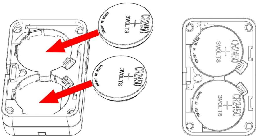
Hinweis: Verwenden Sie zum Einlegen der Batterie einen Schraubendreher oder ein ähnliches Werkzeug, um die Batterieabdeckung zu öffnen.
