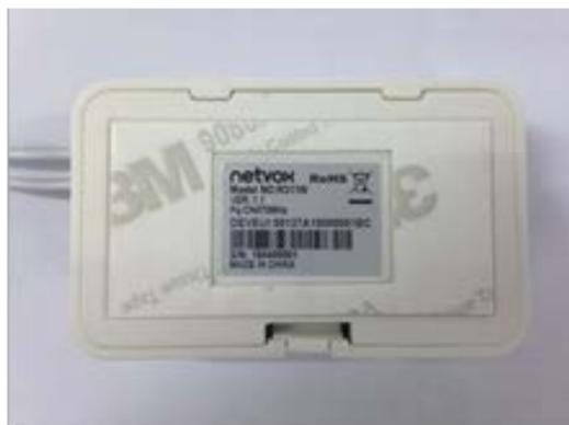
2. Ziehen Sie den 3M-Klebstoff auf der Rückseite des Sensors ab und kleben Sie den Sensor auf den Sitz.
