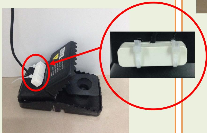
3. Die Abbildung zeigt den Vibrationssensor (R718DA), der an der Mausefalle im Restaurant angebracht ist. Er kann auch in folgenden Szenarien eingesetzt werden:
