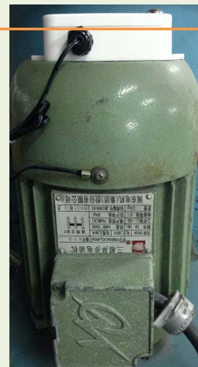
3. Wenn das R718E feststellt, dass die Daten des dreiachsigem Beschleunigungsmessers den ActiveThreshold überschreiten, meldet das R718E die ermittelten Daten.
