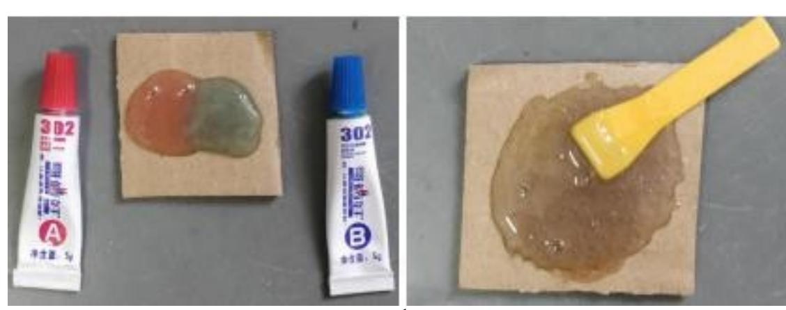
Schritt 8. Tragen Sie den AB-Kleber auf die Unterseite der Halterung auf.
