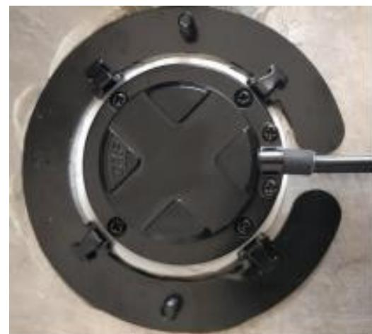
Schritt 13: Bringen Sie die Federhaken am Deckel an und verschließen Sie ihn.
