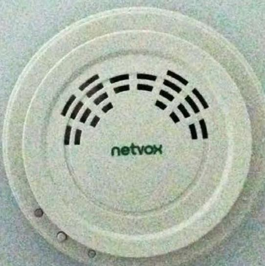
3. Wenn der RA02C eine CO-Konzentration von über 1100 ppm oder eine Temperatur von über 60 °C feststellt, meldet er einen Alarm (Bit = 1).
