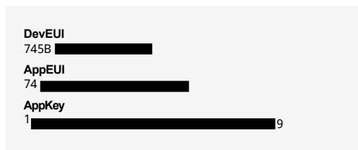
Diese drei Spezifikationen sind gemäß den Anweisungen des jeweiligen Herstellers im LoRaWan-Server zu konfigurieren.
