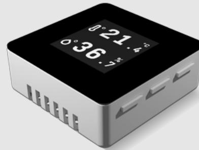
Der Oxobutton 2 wird komplett einsatzbereit geliefert und benötigt lediglich ein LoRaWAN-Netzwerk. Das Paket enthält die drei relevanten Schlüssel (OTAA), mit denen der Oxobutton in Ihr bevorzugtes LoRaWAN-Netzwerk integriert werden kann.
