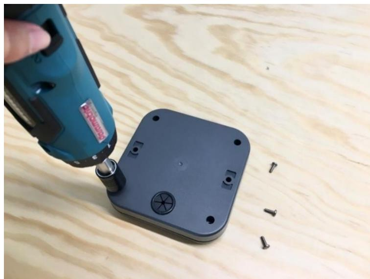
Entfernen Sie die vier Schrauben vom Gehäuse, um Zugang zum Gerät zu erhalten.
