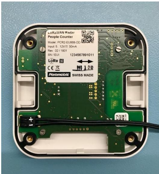
Verwenden Sie eine Gleichstromversorgung mit 5...12 V.
