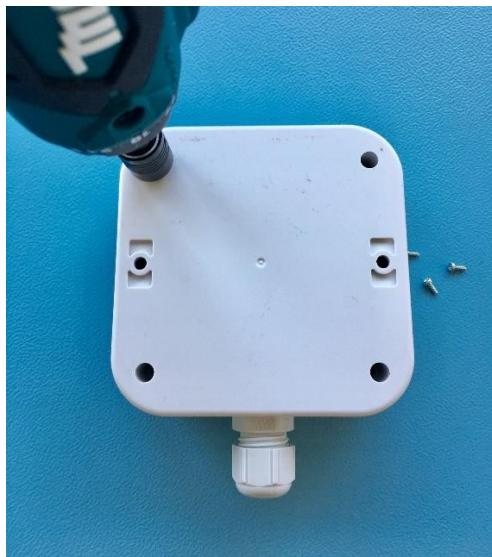
Entfernen Sie die vier Schrauben vom Gehäuse, um Zugang zum Gerät zu erhalten.
