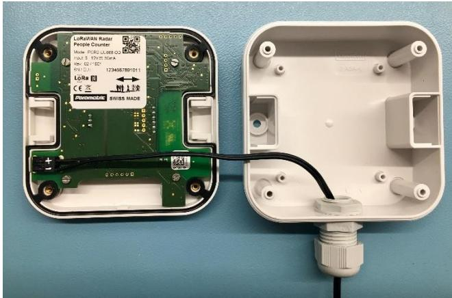
Führen Sie das Kabel durch die Kabelverschraubung.
