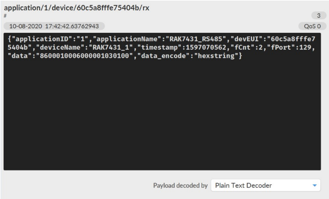
Abbildung 32: Empfangene Nachricht mit LoRa-Konfiguration
