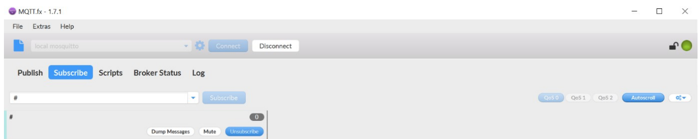
Abbildung 19: Abonnieren des MQTT-Brokers mit Platzhalter
