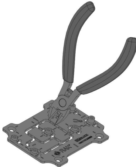
Abbildung 4: Ausschneiden überschüssiger Teile der WisBlock-Innenmontageplatte
