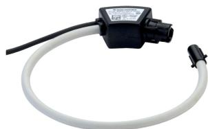
Flexible TF-Stromsensoren messen die Lastströme eines Stromkreises und senden die Daten über eine RJ12-Plug & Play-Verbindung zu den Zählern, Leistungsüberwachungsgeräten oder Strommodulen. Dank ihres breiten Messbereichs decken die TF-Stromsensoren einen Strombereich von 100 bis 6.000 Ampere mit nur 7 Modellen ab. Die flexiblen TF-Stromsensoren können mit DIRIS Digiware I-Modulen, DIRIS A-40 und DIRIS B verwendet werden.
