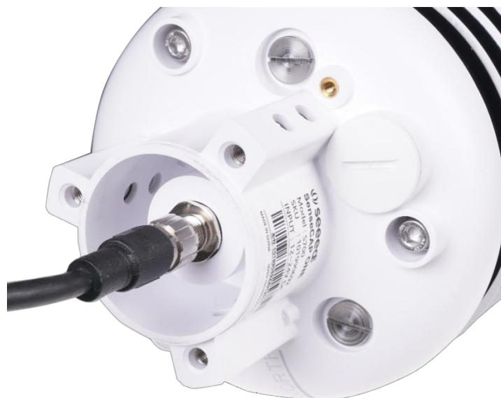
Bei Verwendung des Geräts mit Heizfunktion ist eine separate 24-V-Stromversorgung (24 V bei 1 A empfohlen) erforderlich. Das graue Kabel Nr. 5 wird an den Minuspol der Stromversorgung angeschlossen, das rosa Kabel Nr. 6 an den Pluspol der Stromversorgung.
