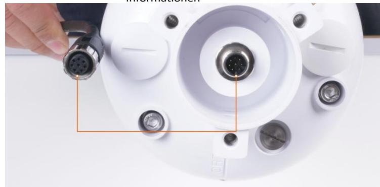
Stecken Sie das Kabel ein und ziehen Sie es im Uhrzeigersinn fest.
