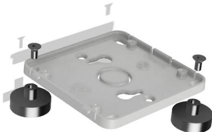
Führen Sie die dafür vorgesehenen Schrauben in die Löcher ein und verbinden diese mit den Magneten.
