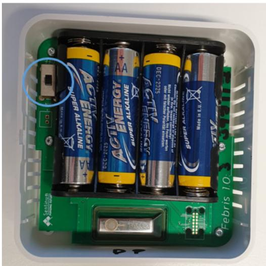
Legen Sie den Schalter von OFF in die Stellung ON. Danach startet der Sensor. Beim Einschalten des Gerätes ist ein Pfeifton zu hören und alle LEDs blinken zusammen. Danach initialisiert sich das Geräte für ein paar Sekunden.
