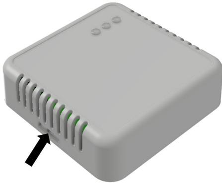
Öffnen Sie das Gehäuse am Schnappverschluss (siehe Pfeil) und nehmen Sie die Oberseite ab. In der Oberseite ist die PCB verschraubt.
